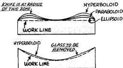
ELLIPSOID, PARABOLOID, HYPERBOLOID
